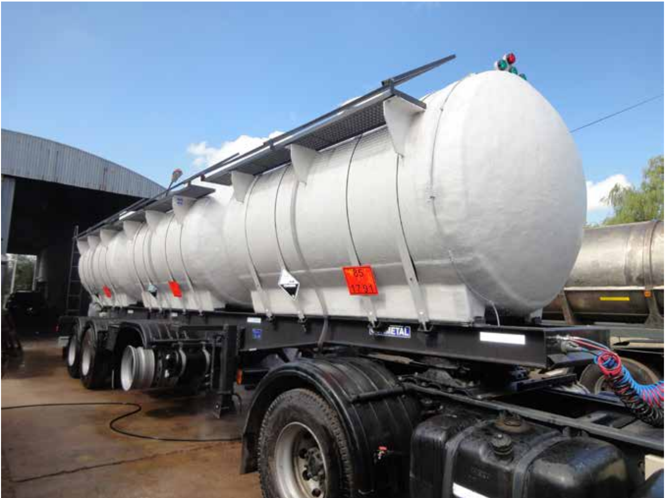
Tanque cisterna de PRFV para corrosivos
