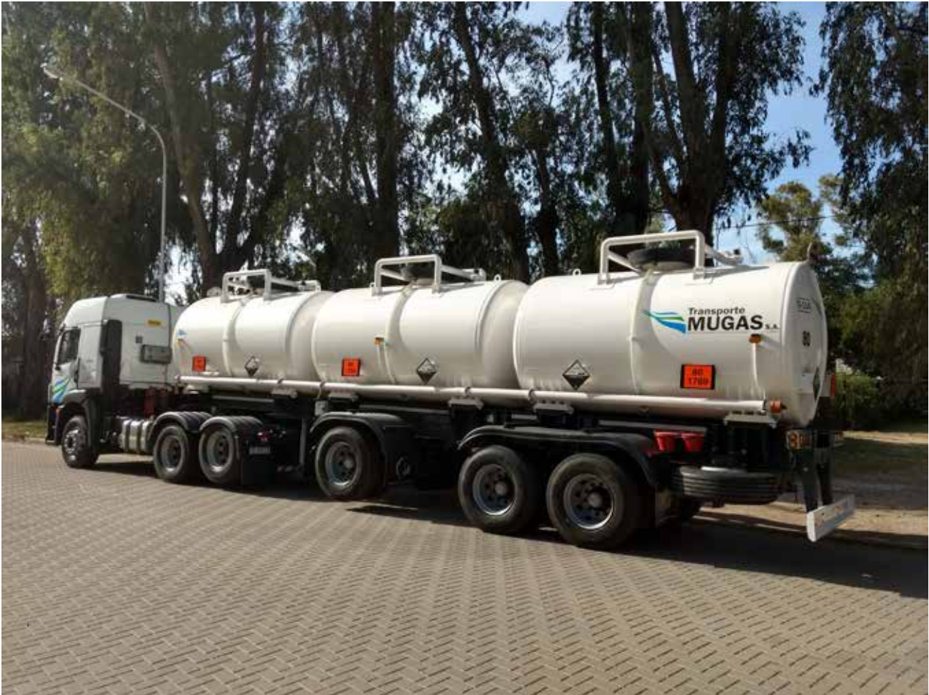
Imagen de cisternas de acero recubiertas con polietileno (PE)
