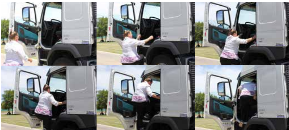
Durante el ascenso y descenso de la unidad, hacerlo siempre tomado del pasamanos de las escaleras.
